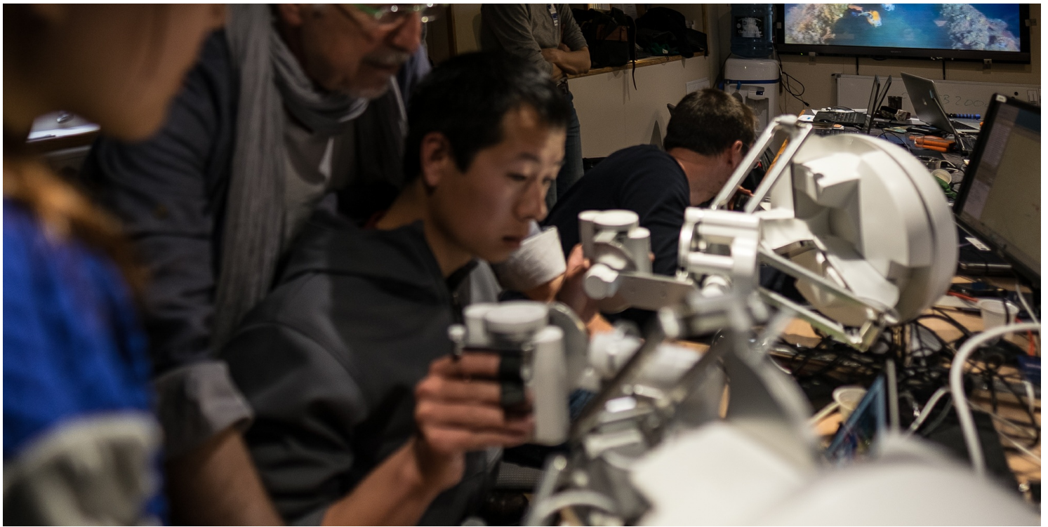
Oussama KHATIB et l'opérateur Brian SOE : ce que touche Ocean One, l'archéologue le ressent à son tour, grâce à des sortes de joysticks, appelés interfaces haptiques, restituant les forces. © Frédéric Osada-Teddy Seguin/DRASSM
