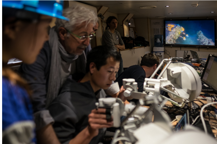
Oussama KHATIB et l'opérateur Brian SOE : ce que touche Ocean One , l'archéologue le ressent à son tour, grâce à des sortes de joysticks, appelés interfaces haptiques, restituant les forces. © Frédéric Osada-Teddy Seguin/DRASSM
