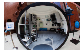
Vue intérieure en coupe de la sphère habitable de l' Archimède , à La Cité de la Mer © Baptiste ALMODOVAR, La Cité de la Mer
