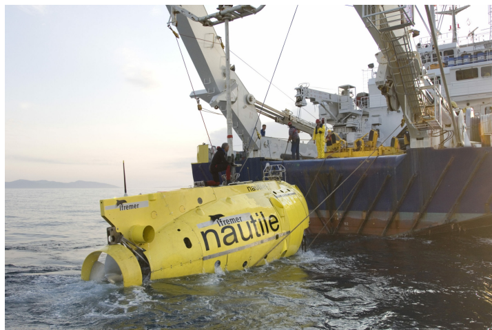
| Le Nautilé, sous-marin scientifique d'observation et d'intervention d'Ifremer
