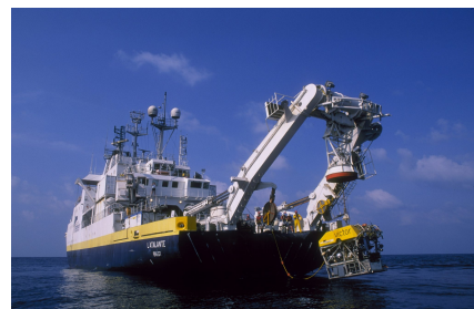
| Mise à l'eau du robot téléopéré Victor 6000
