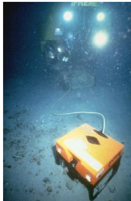
ROBIN : ROBOT d'Inspection du Nautile
