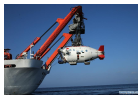
Le Jiaolong est mis à l'eau avec une grue à partir de son navire-support le Xiangyanghong 09
